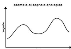
È un segnale continuo nel tempo che può assumere tutti gli infiniti valori della grandezza fisica osservabile, (sia essa una tensione, una corrente, una temperatura o altro...) contenuti all'interno di un determinato intervallo, ovvero tra un minimo relativo ed un massimo relativo.
